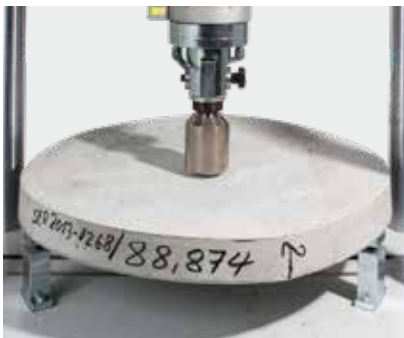
Test met ronde betonplaat (Round panel test): ASTM C1550
