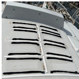
Aanbrengen van de driehoek lijmrupsen Sikasil® SG-20 naast de tape
