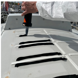
Aanbrengen van de driehoek lijmrupsen Sikasil® SG-20 naast de tape
